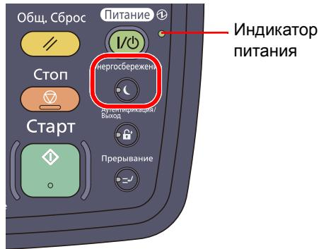
Если в энергосберегающем режиме на аппарат поступают данные печати, он автоматически "пробуждается" и начинает печатать. То же самое происходит, если на находящийся в режиме энергосбережения аппарат поступают факсимильные данные (при использовании отдельно поставляемого факса).
