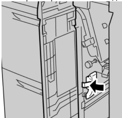
4. Закройте переднюю крышку податчика большой емкости для бумаги большого формата.
