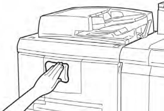
2. Удалите избыток воды с внешних поверхностей с помощью мягкой ткани.
