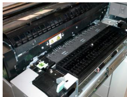
Модуль разглаживания листов в печатающем устройстве
