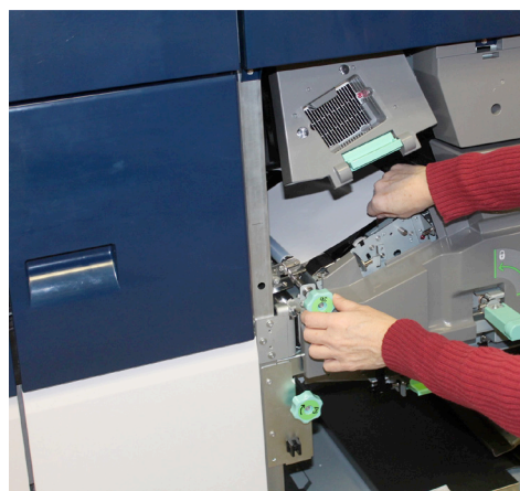
Автоматическое устранение замятий и удаление замятых листов
