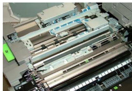
Транспортный механизм модуля выравнивания обеспечивает приводку бумаги с точностью до +/- 0,5 мм.
