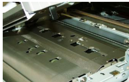
Выравниватель устраняет перекос бумаги и опускается, когда лист передается на контактный датчик изображения для дополнительной регулировки положения листа.
